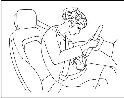
Cuando la mujer embarazada conduce o viaja con el vehículo, debe observar las instrucciones especiales del médico. Deben utilizarse cinturones de seguridad de tres puntos cuando se conduzca o viaje en un vehículo. El cinturón de seguridad en el hombro debe colocarse en la posición adecuada sobre el pecho y el cinturón de seguridad de la pelvis debe colocarse lo más bajo posible. El cinturón de seguridad
