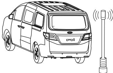
Si el vehículo tiene antena o radio de alta frecuencia , si el vehículo está corriendo en un lugar donde hay antena o radio de alta frecuencia, el sistema asistente de estacionamiento tal vez alarma erróneamente.
