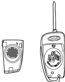
Cuando la batería está descargada o tenga bajo nivel de carga, tiene que presionar varias veces las teclas para cerrar o abrir puertas, la luz indicadora tampoco se enciende. Tiene que reemplazar baterías.
