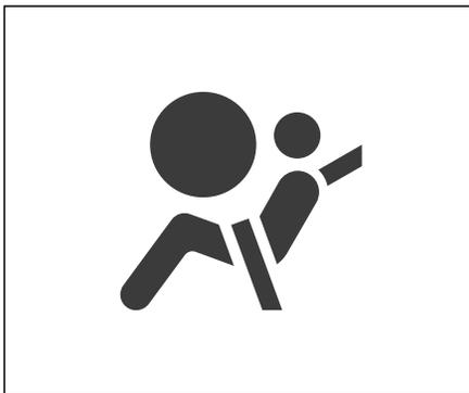
La luz de advertencia de bolsa de aire de seguridad monitorea el estado del sistema de bolsa de aire de seguridad, el circuito del sistema de pretensado del cinturón de seguridad y todas las líneas pertinentes. Cuando el interruptor de encendido se encuentra en "ON", el sistema realiza un autodiagnóstico primero, la luz de advertencia de bolsa de aire de seguridad se apaga después de varios segundos de encendido, eso significa que el sistema se encuentra en un estado de funcionamiento normal.
