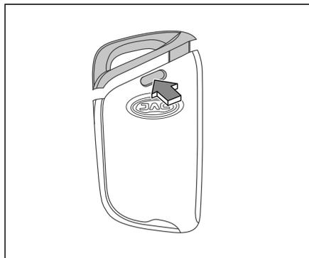
2. Inserte la llave mecánica en el cilindro de la cerradura, gírela en sentido antihorario para bloquear todas las puertas y en sentido horario para desbloquear todas las puertas.
