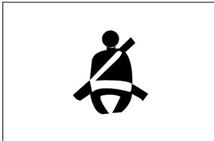
Si el vehículo comienza a conducir sin usar el cinturón de seguridad, o si el cinturón de seguridad se desabrocha durante la marcha, el sistema emitirá sonido de alarma, mientras tanto, luz de advertencia permanece encendida o parpadea. La luz de advertencia de cinturón de seguridad no abrochado se apaga y el sonido de alarma desaparece después de que el conductor o el pasajero delantero se haya abrochado bien el cinturón de seguridad.
