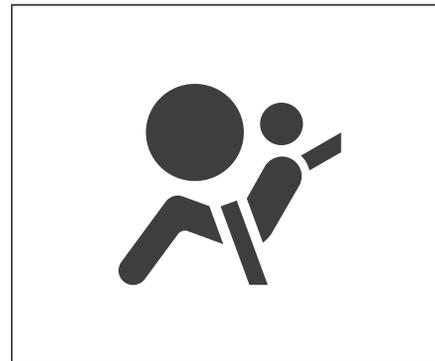
La luz de advertencia de bolsa de aire monitorea el estado del sistema de bolsa de aire, el circuito del sistema de pretensado del cinturón de seguridad y todas las líneas pertinentes.
